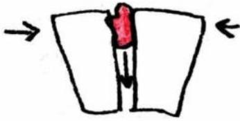
Quand nous allons appuyer sur la brique pour la coller, il faut veiller à répartir équitablement la barbotine sur toute la surface de la brique avec la force exercée. Les points de colle se situent donc à l'extérieur de l'alandier. Si nous mettons de la barbotine sur la zone la plus fine de la brique lors du placement des briques, la barbotine va prendre trop de place et il sera alors difficile d'emboîter les briques sur le gabarit.
